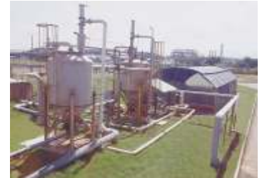
Biofiltro de 144 m 3 , que opera a la salida de la Planta de Tratamiento Anaeróbico de Aguas Residuales de SUCROMILES S.A. con eficiencias de remoción del 99% y cargas aplicadas de 2.3 gr H_2S / m 3 Rh.
